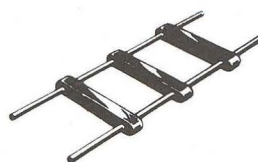
Obr. 10. Vymezení vzdálenosti vodičů dielektrickým žebříčkem
